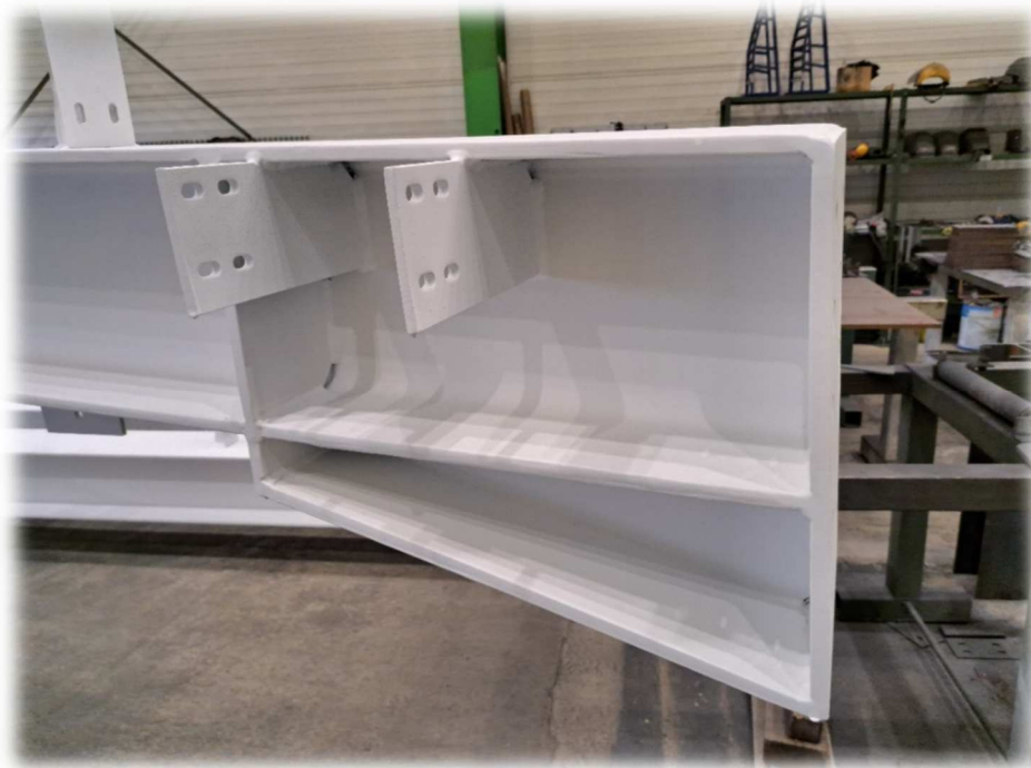
11. ábra Tűzgátló festéssel ellátott szerkezet
